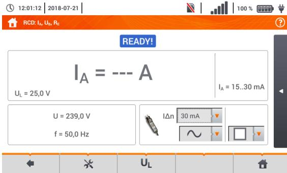
Das Prüfgerät ist bereit zur Messung
